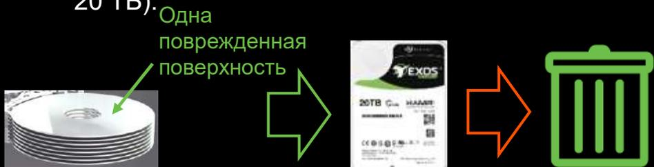
Новый метод: В случае сбоя поверхности ADR восстанавливает диск без неисправной поверхности (пример: 1 ТБ). Теперь жесткий диск стал с емкостью 19 ТБ.
