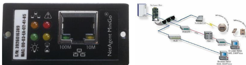
Типова топологія мережевого управління ДБЖ
